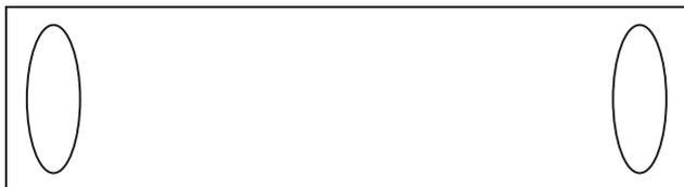
Отверстия по ширине равны диаметру будущих «брёвен», промежутки между краем заготовки (длинная сторона) и краем отверстия составляет примерно 1 см.
